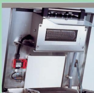
Chauffage de rouleau à figures monté dans le couvercle.
